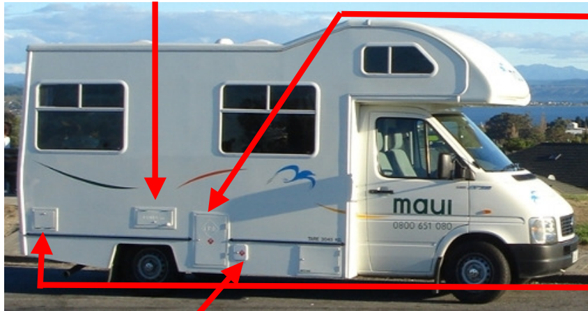
グレイウォーター用ホース: グレイウォーター(シャワーや台所シンクからの汚水)を放出する際のホースが収納されています。 〔注意〕クリアウォーター補給用のホースは車内にあります
