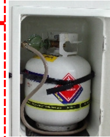
ガスボトル: シャワーのお湯やコンロを使用の際、元栓を開けて使用。使用後は必ず元栓を開けてから走行する事。ガスはガソリンスタンドにて補充できる。
